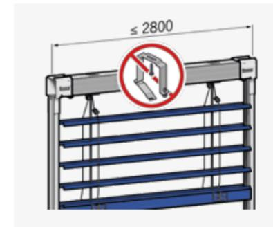
La costruzione autoportante della tenda non danneggia l'isolamento nella veletta e riduce i costi di manutenzione. Fino a una larghezza di 2800 mm, il sistema viene fornito senza fissaggio per il cassonetto superiore: l'isolamento rimane intatto e viene ridotta la trasmissione acustica.
