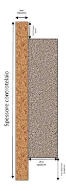
I serramenti e le persiane dovranno essere posate su Sistema modulare isolante termoacustico, costituito da elementi in EPS, accoppiati ad elementi strutturali con funzione di controtelaio per la posa del serramento. Più specificatamente la struttura modulare dovrà essere progettata con quattro lati al fine di eliminare i ponti termici. La densità del materiale isolante di costruzione della spalla laterale e del traverso superiore, dovrà essere ≥ 35kg/m3.
